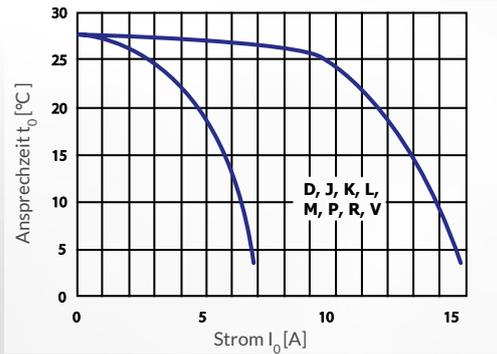
Ausführungsmöglichkeiten des Schalteraufbaus für Strom-Zeit-Anwendungen.
