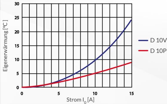
Messung in bewegter Luft mit Anschlusslitzen von 1,5 mm<sup>2</sup>.
